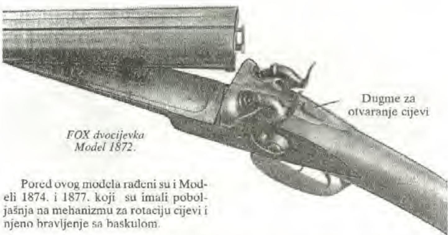
Pored ovog modela rađeni su i Modeli 1874. i 1877. koji su imali poboljšanja na mehanizmu za rotaciju cijevi i njeno bravljjenje sa baskulom.
